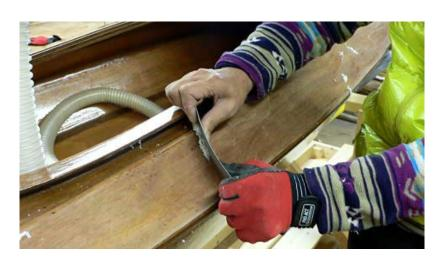
このスクレーパー、ただの0.6mm厚スウェーデン鋼製の板ですが、ごくわずかな返しが付けてあるのでカンナをかけるようにスルスルと堅いエポキシが削れていきますし、サンダーみたいに細かい研磨クズが出ないのがありがたい。
