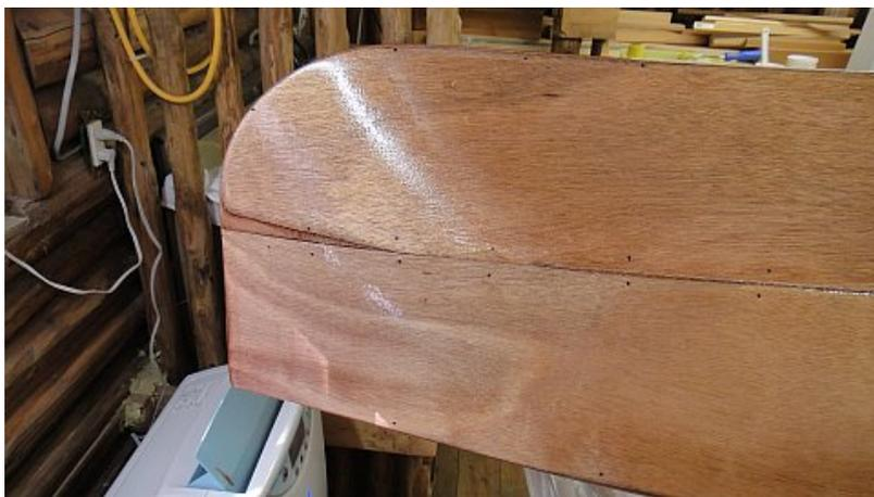
十分に硬化させた後、エポキシが浸透していない針金穴を埋めるなど船体のお化粧をし、軽く全体をサンディングしてからいよいよファイバーグラスに移ります。
