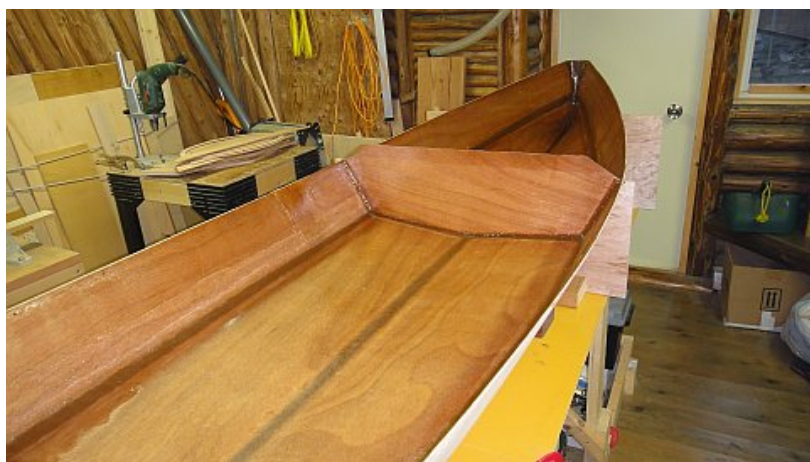
スターン：バルクヘッドまでファイバーグラスラッシング（fill coat前）
