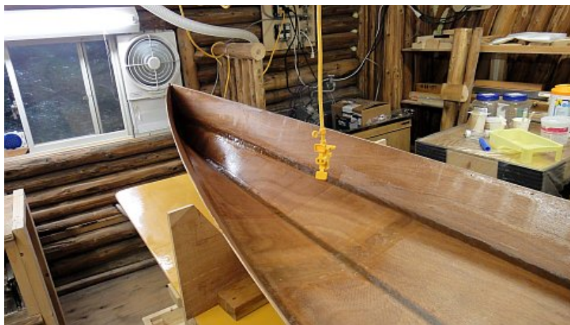
スターン：バルクヘッドまでファイバーグラスラッシング（fill coat前）
