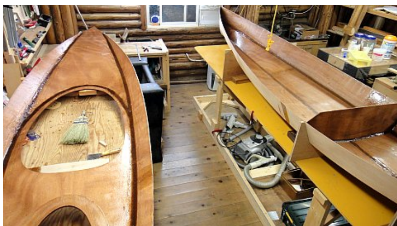
フィルコート（fill coat）したハルとデッキ
