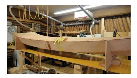
一晩経てばエポキシはタックフリーになりますが、十分な硬化までは達していません。無理矢理締め付けているところもあるため、硬化していないと反発力で剥がれる心配もあり、このままの状態で数日間硬化を待ちました。この後のフィレッティング作業に備えて船を横倒しにしておきましたが、ボトムの形状を始めてしげしげ眺めた気がします。
