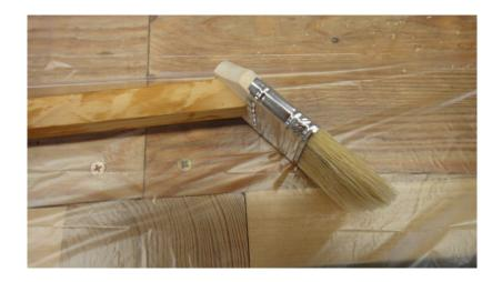
マニュアルにも記載されている通りの刷毛ですが、反対側にはスプーンをくくりつけて、手の届かないバウ、スターンの接合部にフィレッティング用エポキシを運び整形しました。予めエポキシを浸透させたグラステープの端を棒の先にくっつけて、バウ(スターン)の先までソロソロと持っていき、できる限り綺麗に補強しました。でも、写真に見るように出来上がりはさすがに綺麗とは言い難い。
